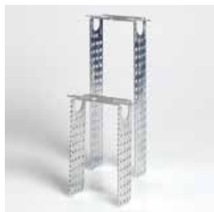
Директен окачвач за CD 60/27 и за дървени летви за директно закрепване 50/120/200 mm дължина на рамото
