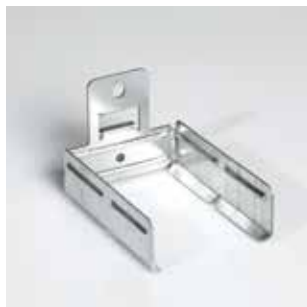
Универсална връзка за CD 60/27 за свързване на профилни съединения на едно ниво с настройване на ъгъла и като надлъжен съединител за CD
