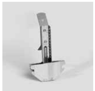
Комбиниран окачвач за CD 60/27 за окачване с тел с ухо или със система Нониус; сигурно прилягане в профила благодарение на двоен клипс, товароносимост в зависимост от приложението
