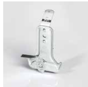
Анкерфикс бърз окачвач за CD 60/27 с блокиране, с въртящо се лостче за фиксиране на профила, за окачване с тел с ухо
